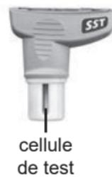
La sonde **PosiTector SST** sont constituées d'une cellule de test spécialement conçue, optimisée pour la plage, la résolution et le volume de test de la méthode de Bresle. Les mesures de conductivité sont compensées à 25° C (77° F) en utilisant un capteur de température intégré. La température de l'échantillon
