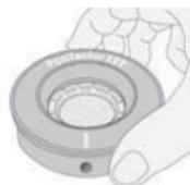
El **PosiTector SST** puede utilizarse como un medidor de conductividad convencional, lo que es ideal para pruebas de materiales abrasivos según ISO 11127-6 y ASTM D4940-15. Consulte **Modo Bresle** (pág. 10).
