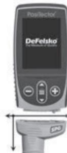
Las sondas **PosiTector SPG** and **SPG S** incluyen una punta cónica (de radio de 50 µm/2 mil) afilada en ángulo de 60° (ASTM D4417 B) o de 30° (Estándar Australiano AS 3894.5) cuyo rango de medición de 500 µm (20 mils)
