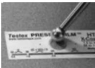
Drücken Sie den Replicafilm (Tape) fest mit dem abgerundeten Ende des beigefügten Glättwerkzeugs aus Edelstahl an, vorzugsweise im Kreisausschnitt. Wenden Sie ausreichend Druck in einer kreisförmigen und in x-y-Richtung durchgeführten Reibebewegung auf, um einen Abdruck mit einem gleichförmigen Kieselsteinaussehen
