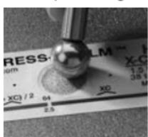
et 60 secondes pour comprimer entièrement toutes les parties du film sur toutes les surfaces. En général, il est préférable d'appliquer une compression plus importante que pas assez. Une fois le polissage (ou rodage) terminé, retirer le ruban de réplique de la surface.
