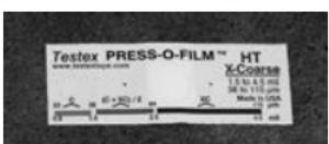
Al colocar la cinta comprimida (réplica) en el **PosiTector RTR** dará una medida del promedio de la altura máxima entre pico y valle del perfil rugoso de la superficie. El medidor sustraerá automáticamente el espesor del sustrato de poliéster de todas las mediciones.
