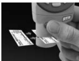
Pour positionner le ruban, aligner les deux points (imprimés sur le ruban de réplique) avec les flèches situées sur les deux côtés de l'ouverture de mesure.
