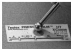
Comprima firmemente la película de réplica utilizando el extremo redondeado de la herramienta de pulido de acero inoxidable. Aplique una presión suficiente en círculo y frote en sentidos transversales para producir una réplica con un aspecto de grano uniforme. Normalmente se requieren de 30 a 60 segundos para comprimir completamente todas las partes de la película en la mayoría de las superficies.
