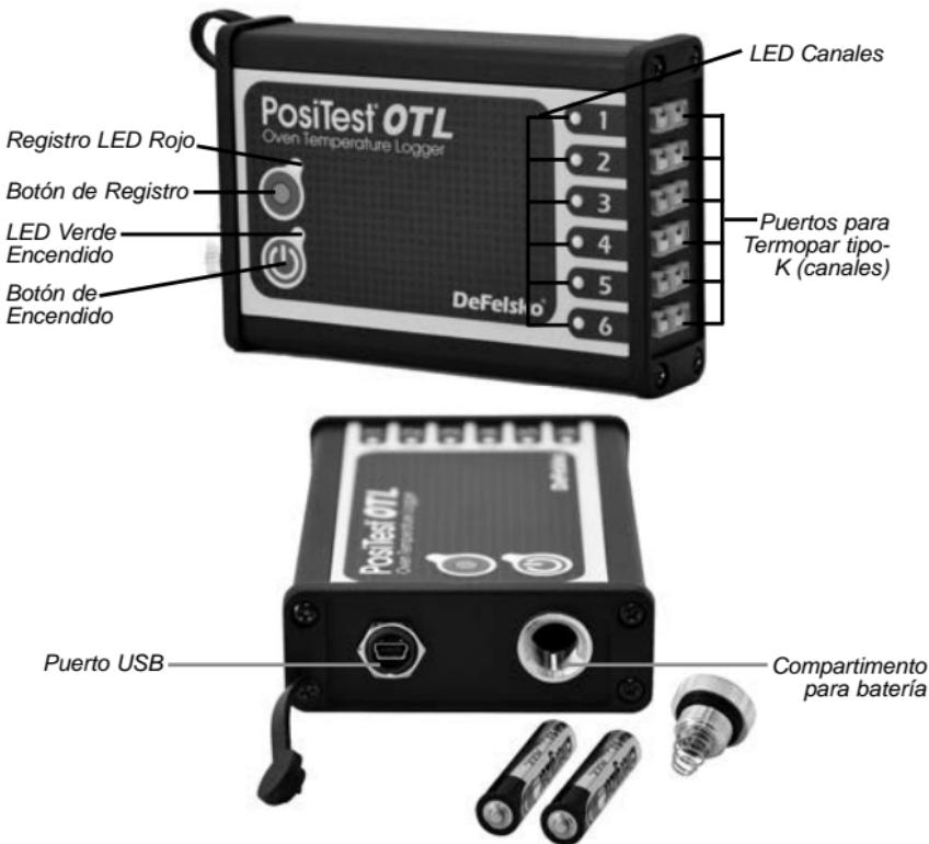
Las instrucciones para la operación básica del **PosiTest OTL** se ubican en la parte posterior del panel del equipo.
