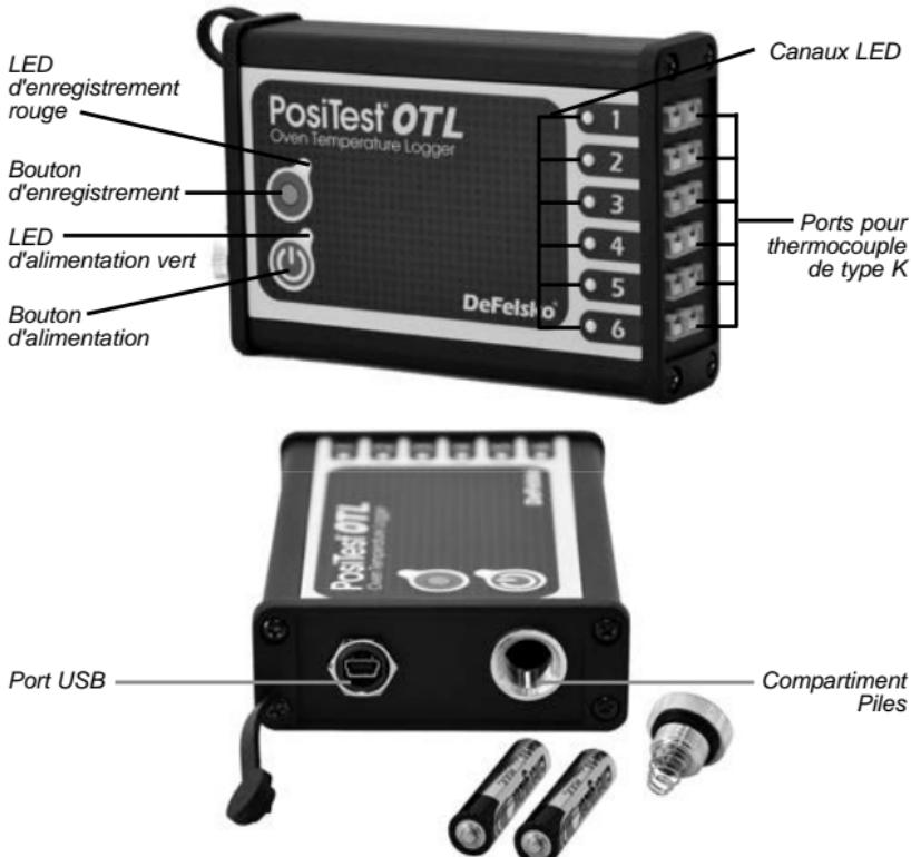
Les instructions de fonctionnement de base se trouvent sur le panneau arrière du **PosiTTest OTL**.
