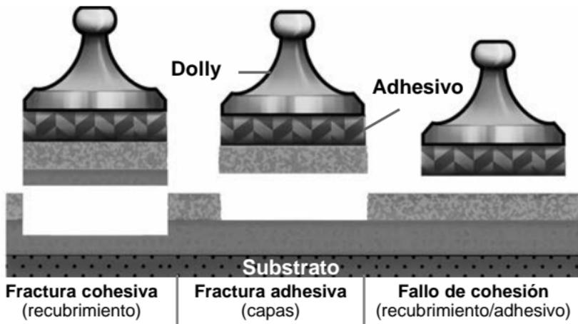
Normalmente se producen fallos de cohesión cuando se mezcla indebidamente el adhesivo o la superficie recubierta no ha sido preparada adecuadamente (pág. 4).
