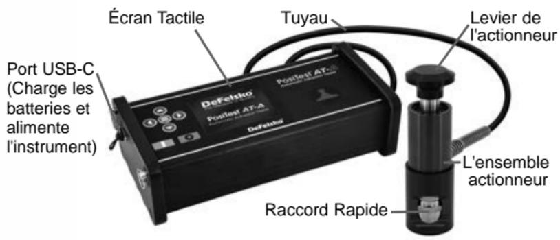
Mettre le **PosiTest AT-A** sous tension en appuyant sur le bouton . Pour préserver l'autonomie de la batterie, l'instrument s'éteint après 5 minutes d'inactivité. Alternativement, appuyer et maintenir le bouton pendant 5 secondes ou sélectionner *Power Off* dans le menu.
