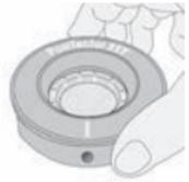
**PosiTector SST**可用作传统的电导率仪，使其成为根据ISO 11127-6和ASTM D4940-15测试研磨材料的理想选择。参见布雷斯勒模式（第8页）。
