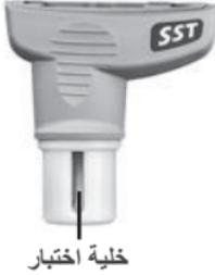
تتكون مجسات **PosiTector SST** من خلية اختبار تم تصميمها خصيصاً لتحسين النطاق والدقة وحجم الاختبار لطريقة **Bresle Method**. يتم تعويض قياسات الموصلية إلى 25 درجة مئوية (77 درجة فهرنهايت) باستخدام مستشعر درجة حرارة مدمج، ويتم تسجيل درجة حرارة العينة لكل قياس. يمكن استخدام المجس كمقياس موصلية تقليدي عن طريق إلغاء تحديد وضع **Bresle Mode** (صفحة 9).
