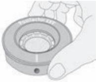
يمكن استخدام جهاز **PosiTensor SST** كمقياس تقليدي لخاصية التوصيل، مما يجعله مثاليًا لاختبار المواد الكاشطة وفقاً لمعيار **ISO 11127-6** ومعيار **ASTM D4940**.
