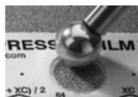
Aplique una presión suficiente en círculo y frote en sentidos transversales para producir una réplica con un aspecto de uniforme.
