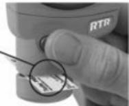
Richten Sie zur Positionierung des Replicafilms (Tape) die beiden auf dem Replicafilm aufgedruckten Punkte auf die Pfeile an den Seiten der Messeöffnung aus.
