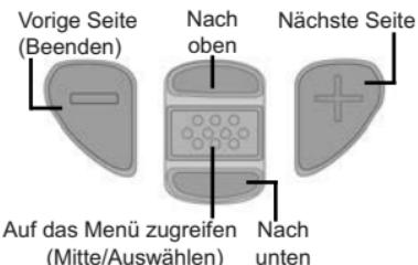
Drücken Sie die Taste (+), um in einem mehrseitigen Menü die Seiten zu wechseln.
