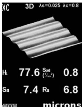
**HINWEIS:** Drücken Sie die Navigationstaste nach oben, um zwischen den 2D- und 3D-Bildern umzuschalten, wenn das Bild nicht automatisch auf der Anzeige erscheint.
