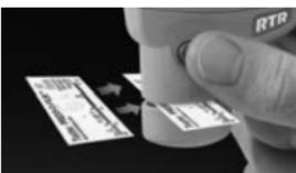
Para colocar la cinta, muévala hacia la parte posterior de la sonda y alinee los dos puntos (impresos en la cinta de réplica) con flechas en ambos lados de la ranura de medición.
