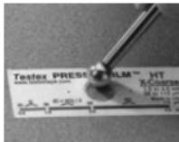
Drücken Sie den Replicafilm mit dem abgerundeten Ende des beiliegenden Glättwerkzeuges aus Edelstahl fest an, vorzugsweise im Kreisausschnitt. Wenden Sie ausreichend starken Druck auf, und zwar in kreisförmigen sowie in x-y-Richtung durchgeführten Reibebewegungen, um einen Abdruck mit einem einheitlichen Erscheinungsbild zu bilden. **Seien Sie vorsichtig, denn ein zu festes Andrücken kann den Polyesterfilm beschädigen.**
