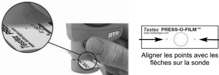
Si un ruban plus ancien est utilisé et ne dispose pas de points imprimés, il suffit de procéder à l'alignement en centrant le dit ruban dans l'ouverture de mesure.
