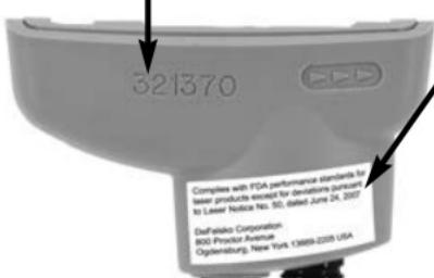
Etiqueta de identificación y calibración del fabricante.
