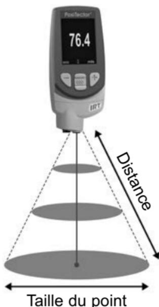
Le rapport entre la distance et la taille de la cible correspond à la relation entre le diamètre de la zone mesurée et la distance de l'instrument par rapport à la zone. Lorsque la distance (D) à la cible mesurée augmente, la taille de la zone mesurée (S) devient plus grande. Le rapport D: S du **PosiTector IRT** est de 5.7:1. Par exemple, lorsque l'instrument est à 100 cm (40 pouces) de la cible, la taille du point sera de 18 cm (7 pouces) de diamètre.
