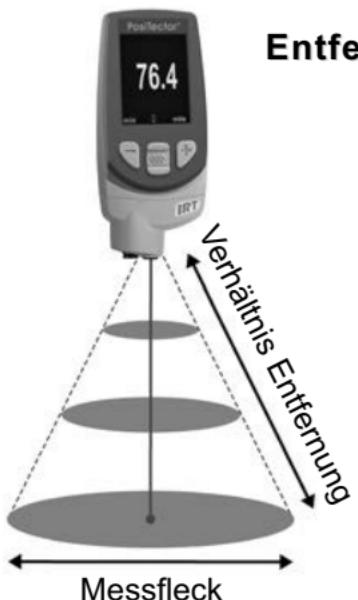
Dies bezeichnet das Verhältnis zwischen dem Durchmesser der zu messenden Fläche und der Entfernung des Messgerätes von dieser Fläche. Sobald die Entfernung zu der zu messenden Fläche zunimmt, vergrößert sich proportional dazu der Messfleck. Das PosiTector IRT besitzt eine 5.7:1-Optik.
