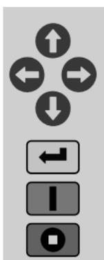
Les boutons directionnels sont utilisés pour naviguer dans les options du menu et régler les paramètres.
