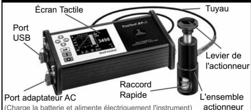
Mettre le PosiTector AT-A sous tension en appuyant sur le bouton . Pour préserver l'autonomie de la batterie, l'instrument s'éteint après 5 minutes d'inactivité. Alternativement, appuyer et maintenir le bouton pendant 5 secondes ou sélectionner *Power Off* dans le menu.
