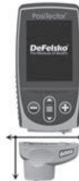
An **PosiTector-Grundgeräte** können eine Vielzahl unterschiedlicher Sonden angeschlossen werden, zum Beispiel magnetische, Wirbelstrom- und Ultraschall-Schichtdickensonden, Sonden zur Messung des Oberflächenprofils, klimatischer Parametern und Taupunkt, Härte, Salzgehalt, Glanz, und Ultraschall-Wanddicke. Weiterführende Informationen:
