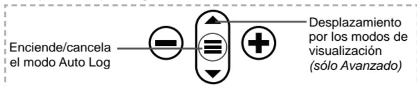
**Los modelos Estándar** quedarán encendidos durante el modo Auto Log. El equipo realizará lecturas durante unas 50-60 horas con pilas alcalinas, dependiendo de la frecuencia de medición.
