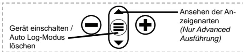
**Standardmodelle** bleiben im Auto Log - Modus eingeschaltet. Mit einem Satz Alkalibatterien nimmt das Gerät 50-60 Stunden lang Messwerte auf, je nach dem wie häufig gemessen wird.
