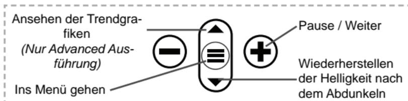
Die Taste Pause/Weiter ⊕ hält die Werte aus der automatischen Aktualisierung fest, um eine genauere Untersuchung der Beziehungen der Werte untereinander zu ermöglichen oder um Zeit für die manuelle Aufzeichnung des gesamten Datensatzes zu haben. Drücken Sie erneut die Taste ⊕, um fortzufahren.
