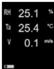
**Hinweis:** Der Taupunkt (Td) und die Oberflächentemperatur (Ts) werden nicht angezeigt, wenn das **Anemometer** eingeschaltet ist.
