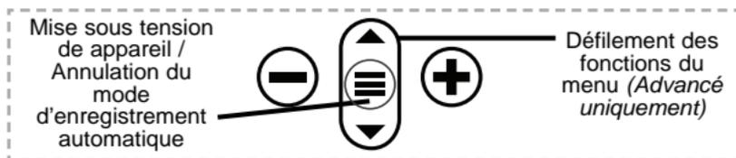
Les **Modèles Standard** restent sous tension en mode d'enregistrement automatique. L'instrument peut prendre des mesures pendant 50 à 60 heures avec les piles alcalines, selon la fréquence des mesures.
