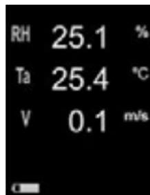
**Remarque:** Le point de rosée (Td) et la température de surface (Ts) ne sont pas affichés lorsque **l'anémomètre** est activé.
