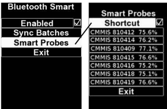
Setzen Sie ein Häkchen bei der Option „Shortcut“ im Untermenü „Smart Probes“ (Hauptmenü > Connect > Bluetooth Smart > Smart Probes), um direkt vom Hauptmenü des Gerätes zu diesem Untermenü zu gelangen.
