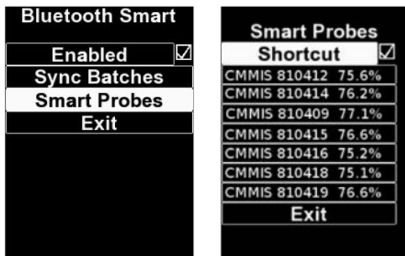
3. Un **PosiTector DPM Advanced** mostrará la humedad relativa y la temperatura de la sonda **PosiTector CMM IS** al igual que la humedad relativa del ambiente y la temperatura del aire de la sonda conectada **PosiTector DPM**, como se muestra a continuación:
