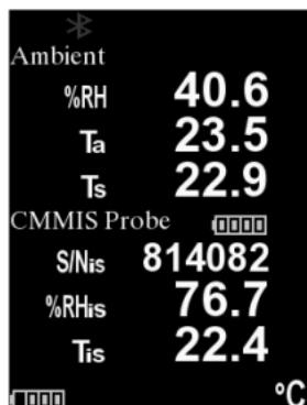
Pour enregistrer, s'assurer qu'un lot est ouvert dans la mémoire et cliquer sur le bouton (+) de l'instrument. Les lectures affichées de la sonde **PosiTector DPM** et de la sonde **PosiTector CMM IS** seront enregistrées dans la mémoire de l'instrument.
