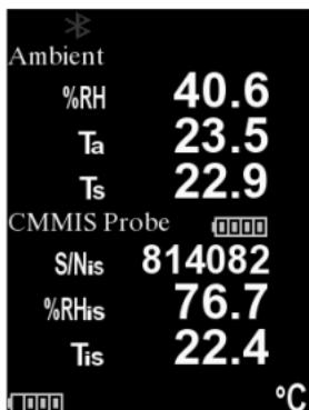
Para registrar, asegúrese de que hay un lote abierto en la memoria y pulse el botón (+) del medidor. Las lecturas mostradas de las sondas del **PosiTector DPM** y del **PosiTector CMM IS** se registrarán en la memoria del medidor.
