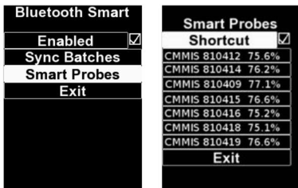
3. Un instrument **PosiTector DPM Advanced** affiche l'humidité relative et la température de la sonde **PosiTector CMM IS** ainsi que l'humidité relative et la température de l'air ambiantes de la sonde **PosiTector DPM** connectée, comme ci-après :
