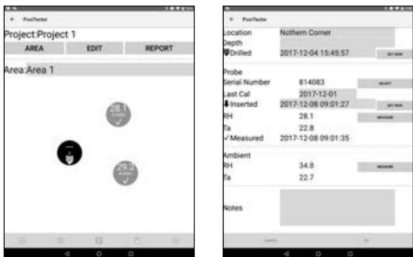
Die relative Feuchtigkeit in der Umgebung und die Lufttemperatur (über dem Loch) können auch mit einer zusätzlichen PosiTector CMM IS - Sonde oder einem PosiTector-DPM-Advanced-Messgerät aufgezeichnet werden. Das verwendete Messgerät zur Messung der Klimabedingungen wird in der Projekteinrichtung (S. xx) angegeben. Wählen Sie **Messen** und dann **OK**, um die angezeigten Werte zu speichern. Alternativ kann ein Wert relativer Feuchtigkeit und Temperatur auch manuell eingegeben werden.
