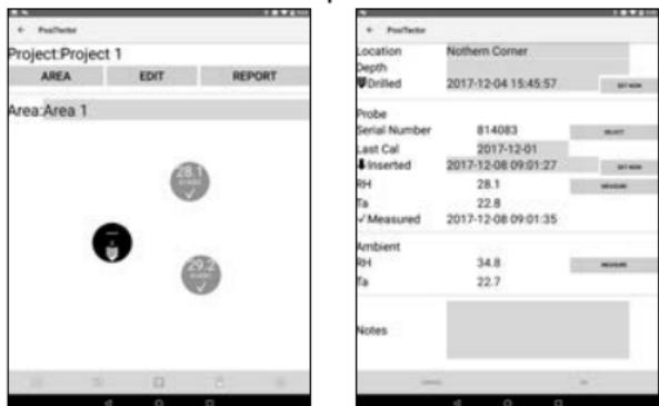
L'humidité relative ambiante et la température de l'air (au-dessus du trou) peuvent également être enregistrées en utilisant une sonde de rechange. **PosiTector CMM IS** ou un instrument **PosiTector DPM Advanced**. L'instrument ambiant utilisé est spécifié dans la configuration du projet (Project) (en page. 6). Cliquer sur Measure, puis sur Ok pour enregistrer les valeurs affichées. Une valeur d'humidité relative et de température peut sinon être saisie manuellement.
