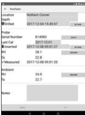
Registre la fecha y la hora en que inserta cada sonda utilizando la **App PosiTector**. Seleccione **Set Now** (Configurar ahora) para introducir automáticamente la fecha y hora actuales o intodúzcalas manualmente.
