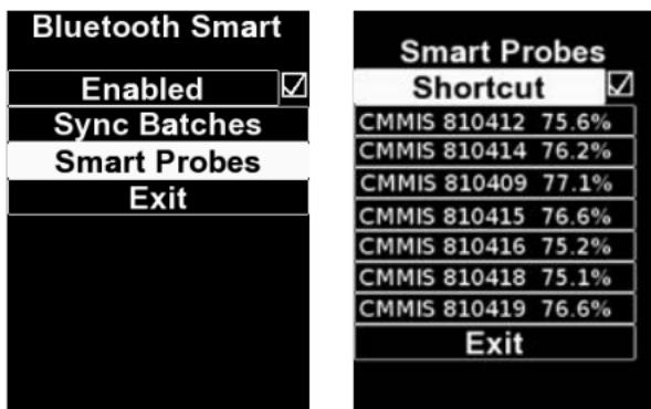
3. Ein **PosiTector-DPM-Advanced**-Messgerät zeigt die relative Feuchtigkeit und Temperatur der **PosiTector CMM IS** - Sonde sowie die gemessene relative Feuchtigkeit und Lufttemperatur der verbundenen **PosiTector-DPM**-Sonde an, wie nachstehend Abbildung zeigt:
