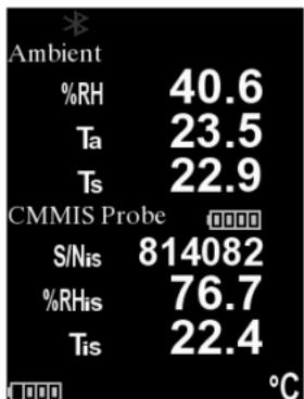
Stellen Sie sicher, dass ein Block im Speicher geöffnet ist und drücken Sie die Taste (+) auf dem Messgerät. Die angezeigten Messwerte der **PosiTector DPM** - Sonde und der **PosiTector CMM IS** -Sonde werden im Speicher des Messgeräts aufgezeichnet.
