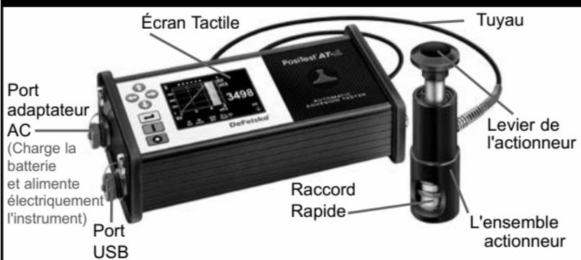
Mettre le **PosiTest AT-A** sous tension en appuyant sur le bouton . Pour préserver l'autonomie de la batterie, l'instrument s'éteint après 5 minutes d'inactivité. Alternativement, appuyer et maintenir le bouton pendant 5 secondes ou sélectionner *Power Off* dans le menu.
