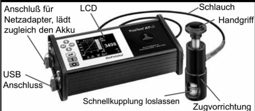
Der **PosiTest AT-A** schaltet sich ein, sobald die Taste gedrückt wird. Das Gerät schaltet sich nach 5 Minuten Inaktivität automatisch ab, um Energie zu sparen. Halten Sie alternativ die Taste für 5 Sekunden gedrückt oder wählen Sie „Ausschalten“ im Menü.
