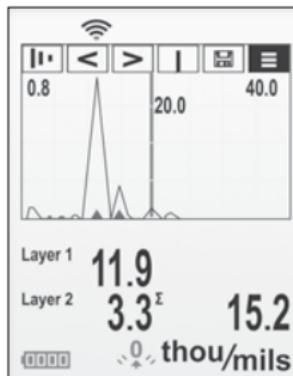
Estas interfaces se representan con un "pico". A mayor cambio de densidad, mayor pico. Cuanto más gradual sea el cambio de densidad, mayor será la amplitud del pico. Por ejemplo, dos capas de recubrimiento compuestas esencialmente por el mismo material y "mezcladas" darían como resultado un pico amplio y de poca altura. Dos materiales de densidad muy diferente y una interfaz bien definida darían como resultado un pico alto y estrecho.
