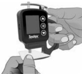
**Remarque:** Nettoyer les enclumes avant de mettre l'instrument sous tension, de le réinitialiser (p. 9) ou à chaque fois que l'instrument n'affiche pas -50 µm (-2,0 mils) lorsque la bande de réplique adhésive est retiré après avoir pris une mesure.
