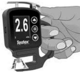
Sobald sich der Messwert stabilisiert, blinkt der angezeigte Wert und wird gespeichert, wenn der Speichermodus aktiviert ist (S. 6).
