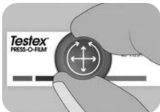
5. Wechseln Sie zwischen linearen (x-y) und kreisförmigen Bewegungen mit dem Anpresswerkzeug, um den Abdruckschaumstoff vollständig zu anzudrücken, bis ein gleichmäßiges grau gepunktetes Aussehen über den gesamten Messbereich erreicht wird.
