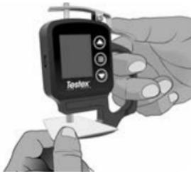
**NOTA:** Limpiar los yunque antes de encender el medidor, de reiniciarlo (pág. 6) o cada vez que el instrumento no indique  $-50 \mu\text{m}$  (-2,0 mils) al retirar la cinta de réplica tras realizar una medición.
