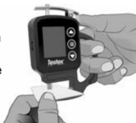
**Hinweis:** Reinigen Sie die Ambosse, bevor Sie das Messgerät einschalten, es auf Null stellen (S. 6) oder immer dann, wenn das Messgerät nicht  $-50 \mu\text{m}$  (-2,0 mils) anzeigt, sobald das Replicaband entfernt wird.
