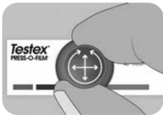
5. Alterner entre les mouvements linéaires (x-y) et circulaires avec l'outil de brunissage pour brunir complètement la réplique en mousse jusqu'à ce qu'un aspect gris pointillé uniforme soit obtenu sur toute la zone de mesure.
