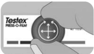
5. Utilizar la herramienta de pulido, alternando movimientos lineales (x-y) y circulares para pulir totalmente la espuma de réplica hasta obtener un aspecto gris punteado uniforme en toda la zona de medición.
