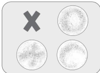
6. Entfernen Sie sorgfältig das angepresste Replicaband von der Oberfläche. Ein kleines Stück Trägerpapier verbleibt bei einigen Replicabandtypen in der oberen linken Ecke, um ein leichteres Ablösen zu ermöglichen.
