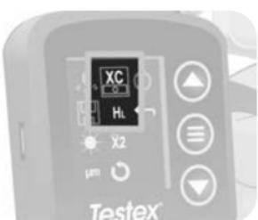
9. Stellen Sie sicher, dass der richtige Replicabandtyp gewählt wurde (S. 1) und das Symbol HL (S. 8) an der Unterseite des Bildschirms angezeigt wird.
