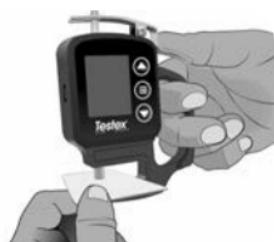
**참고:** 영점을 조정(p.6)하거나, 측정 후 복제 테이프를 제거할 때 게이지가  $-50 \mu\text{m}$ (-2.0 mils)을 표시하지 않으면 게이지를 켜기 전에 앤빌을 청소합니다. 청소 후 **≡** 버튼을 눌러 Testex 디지털 마이크로미터의 전원을 켕니다.
