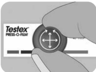
5. 使用抛光工具交替进行线性(x-y)和圆周运动，完全抛光复制泡沫，直到整个测量区域表面呈现均匀的点状灰色外观。
