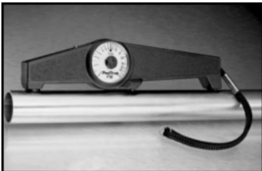
Pour la mesure non-destructive des revêtements non-magnétiques (peinture, émail, galvanisation, métallisation, électrodéposition, etc.) sur l'ACIER.
