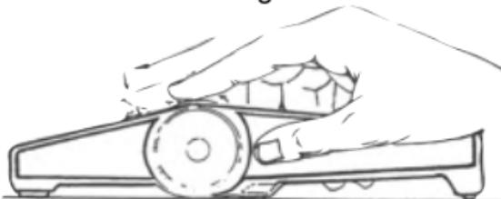
**Zweitens:** Sobald die Sichtanzeige unten bleibt: mit Ihrem Zeigefinger das Einstellrad langsam in die Gegenrichtung drehen, bis Sie ein Klickgeräusch hören und die Sichtanzeige herausspringen sehen. An dieser Stelle die Beschichtungsdicke auf der Skala ablesen.
